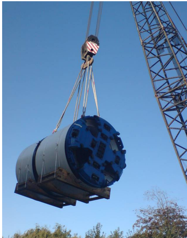
Abb. 1: Vortriebsmaschine der Firma Herrenknecht
