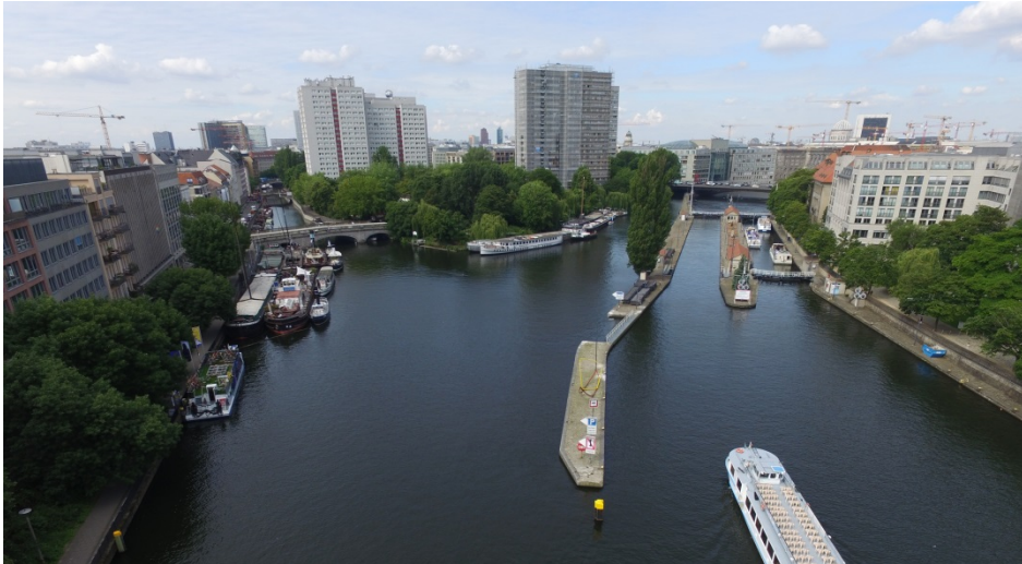
Blick auf das Oberwasser der Staustufe Mühlendamm, v. l. n. r.: Märkisches Ufer, Abzweig Spreekanal mit Roßstraßenbrücke, Fischerinsel, Wehrgraben Mühlendamm, Doppelschleuse Mühlendamm. Mit ca. 36.000 geschleusten Wasserfahrzeugen pro Jahr zählt die Berliner Mühlendamm Schleuse zu den verkehrsreichsten Schleusen an den Binnenwasserstraßen des Bundes.
