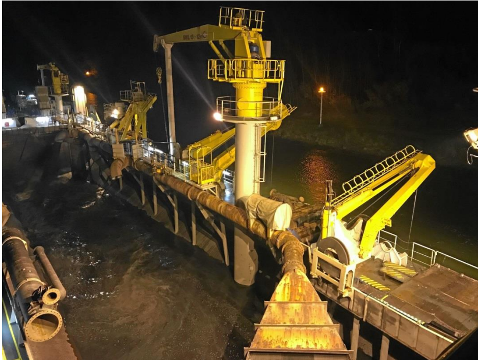
Bei Nacht: Teilgefüllter Laderaum während des Baggerns unter fortwährendem Einstrom von Gemisch
