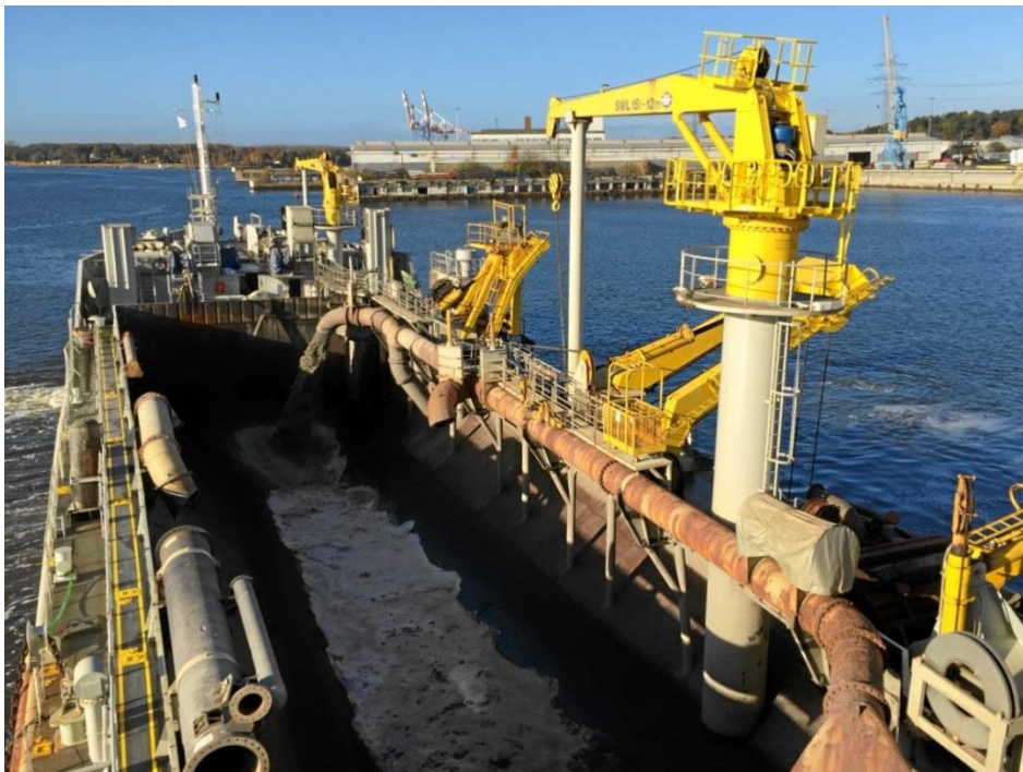
Laderaum beginnt sich gerade mit Baggergut–Wasser–Gemisch zu füllen
