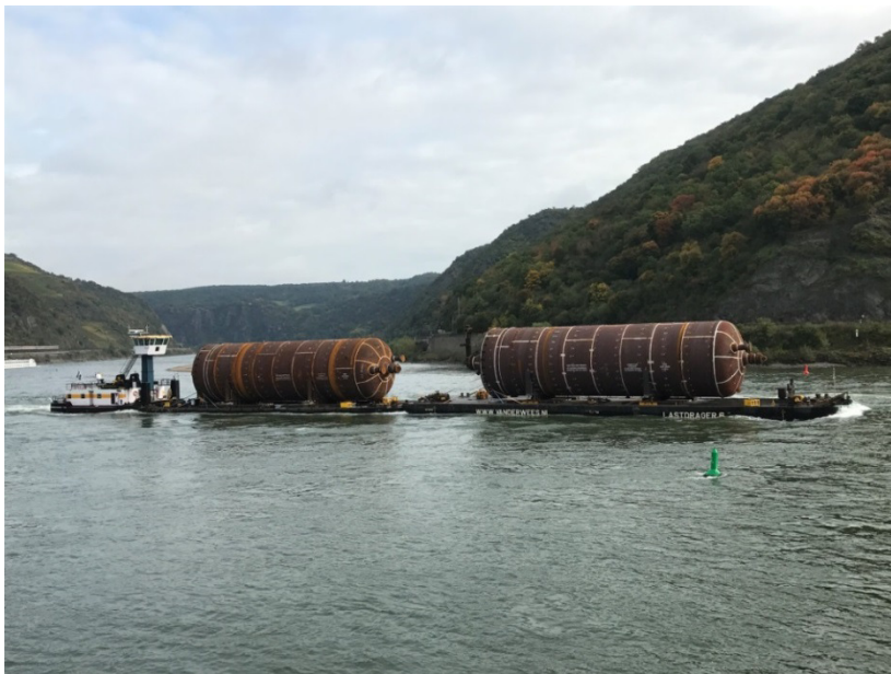
Schubverband, bestehend aus Schubboot und 2 Ladungspontons, mit den Koksbehältern bei Rhein-km 550 (ca. 4 km oberhalb der „Loreley“)
