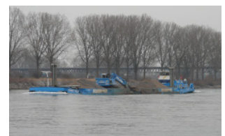
Gütermotorschiff mit geladenem Baggergut auf der Fahrt zur Verklappstelle
