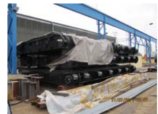
Fertige Schleusentore bei SIBAU Genthin
