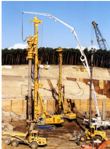
Abb. 5 Bohrgerät Bauer BG 42
